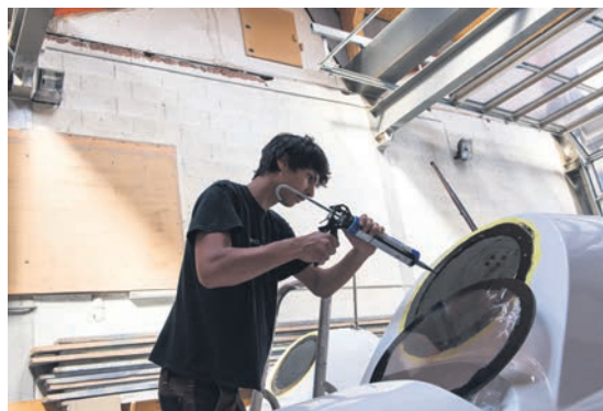
Un des employés de Stéphane Allemano pose les hublots du catamaran de la Fondation Just for Smiles.
